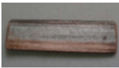
Рис. 2. Локальне легування сталі та міді наночастками латуні, алюмінію та графіту
