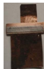
Рис. 2. Локальне легування сталі та міді наночастками латуні, алюмінію та графіту
